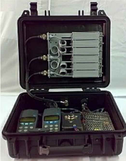
Ove poi non fosse possibile individuare un ponte radio che possa servire quell'area specifica sarà sufficiente andare sul luogo ed “accendere” un ponte radio portatile, in modo da ristabilire le comunicazioni.
