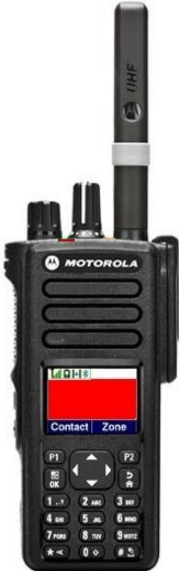
Premendo il pulsante PTT (Push To Talk) verrà spenta la parte ricevente ed attivata la parte trasmittente.
