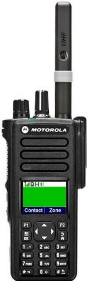
Al momento dell'accensione lo switch PTT è rilasciato. La radio automaticamente attiverà il ricevitore disattivando la parte trasmittente. In questo modo funzionerà come un qualsiasi ricevitore che usiamo per ascoltare la musica.
