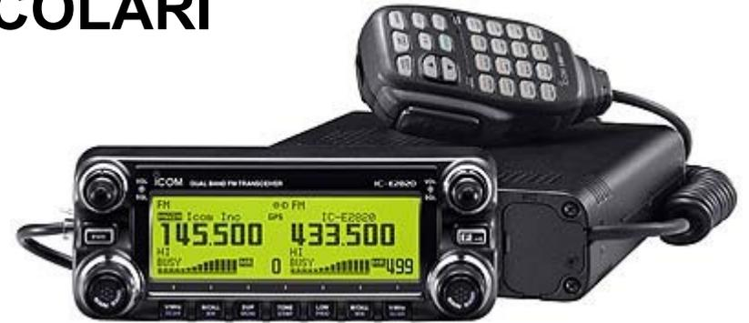
Si tratta di apparati meno compatti dei portatili e con delle potenze di uscita più elevate (dell'ordine dei 20 Watt). Non hanno alimentazione propria e quindi per funzionare devono essere collegati alla batteria del veicolo che li ospita, o ad un alimentatore a 12 Volts ma di potenza idonea.
