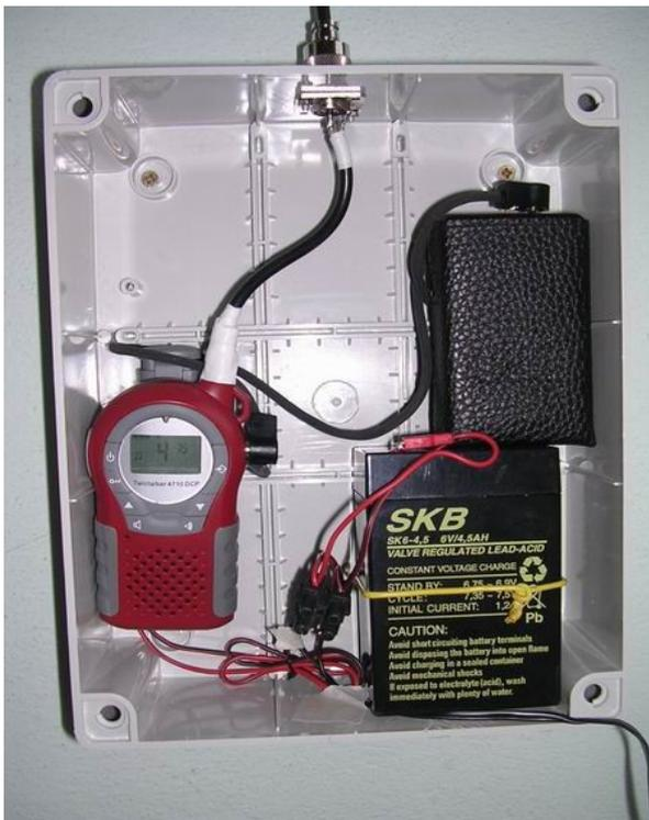
Visto che il suo compito è prettamente "meccanico", l'operatore D può essere sostituito dalla "scatoletta" a destra. Si tratta di un Ponte Radio Parrot, uno strumento che registra il messaggio in entrata, e lo ritrasmette al termine della trasmissione.
